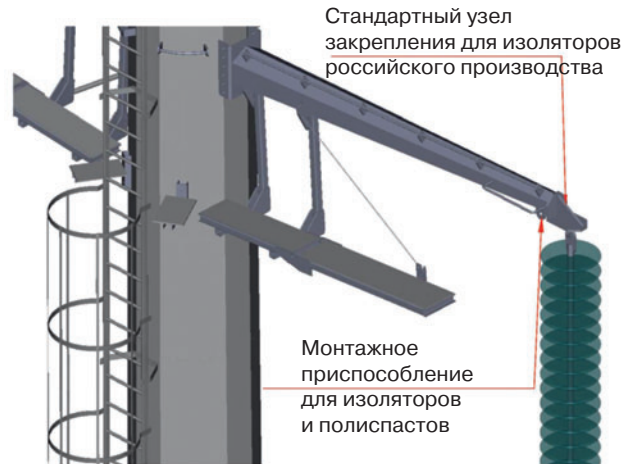
Рис. 4. Узел траверсы для монтажа и закрепления изоляторов
